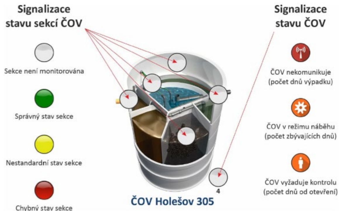
Čistírna je vybavena několika senzory pro dálkové monitorování správné funkce.
