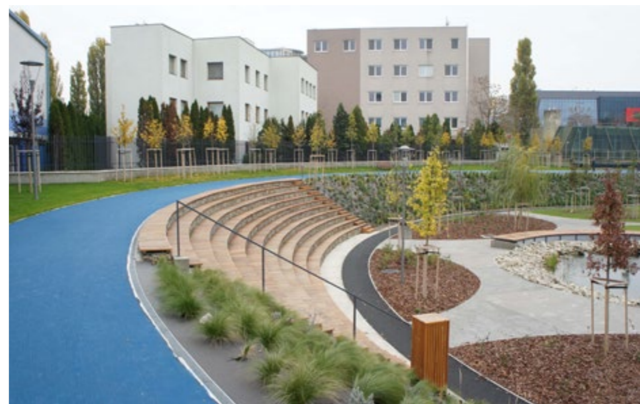
Drenážní beton na chodnících propouští 95 % dešťové vody.
