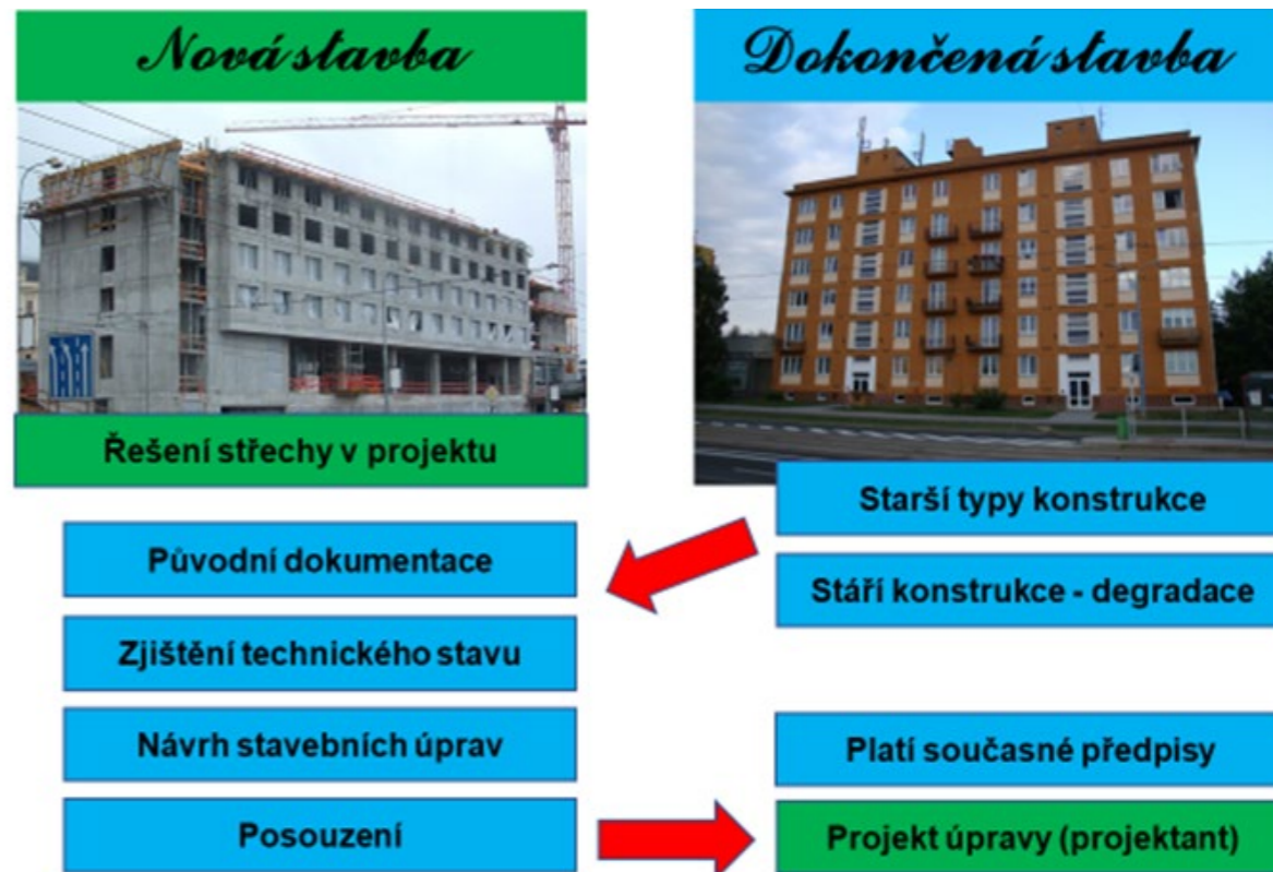
Schéma postupu pro ověření stávající střechy u dokončené stavby pro její úpravu na střechu zelenou.
