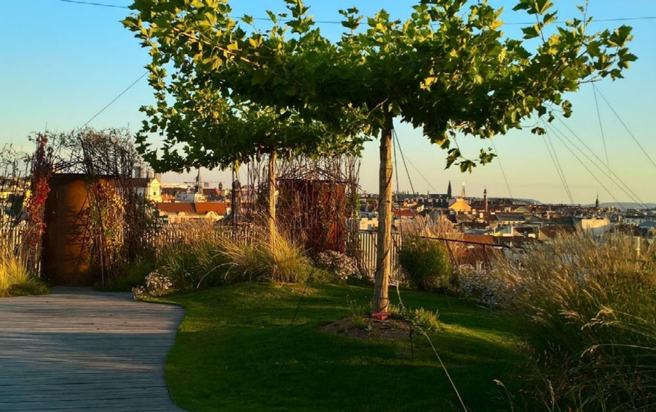
Zelená intenzivní a pobytová střecha na budově Drn na Národní třídě v Praze. Intenzivní zelená střecha (střešní zahrada) představuje velkorysejší řešení ozelenění s vyššími rostlinami i s intenzivnějšími porosty. Tloušťka vrstvy substrátu je přibližně nad 300 mm a více, její specifikou je zavlažovací zařízení. Polointenzivní střechy mají výšku substrátu 150–300 mm, jedná se o kompromisní řešení mezi požadavky na zelesň a tíhou substrátu. (Foto: autor)
