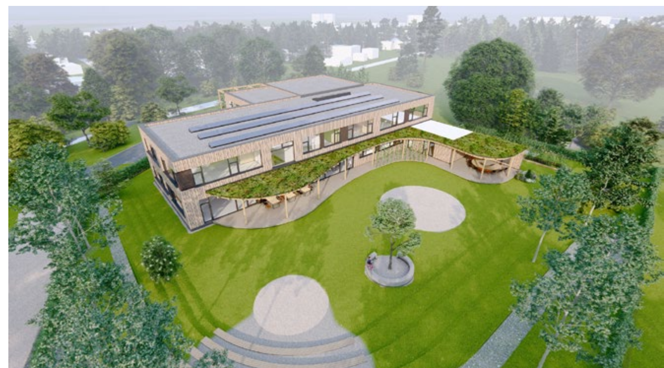
Škola je navržena z masivních dřevěných panelů tl. 135 a 81 mm v kombinaci s těžkým dřevěným skeletem.
