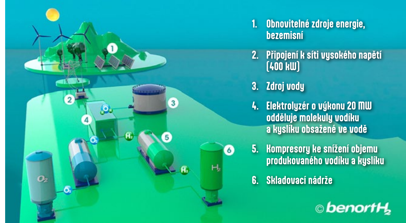
BenorthH2 ve Španělsku využívá obnovitelných zdrojů energie (sluneční, větrná). Vyrobený vodík by měl být vstřikován do stávající plynárenské infrastruktury společně a v pěti-procentní koncentraci mixován se zemním plynem.
